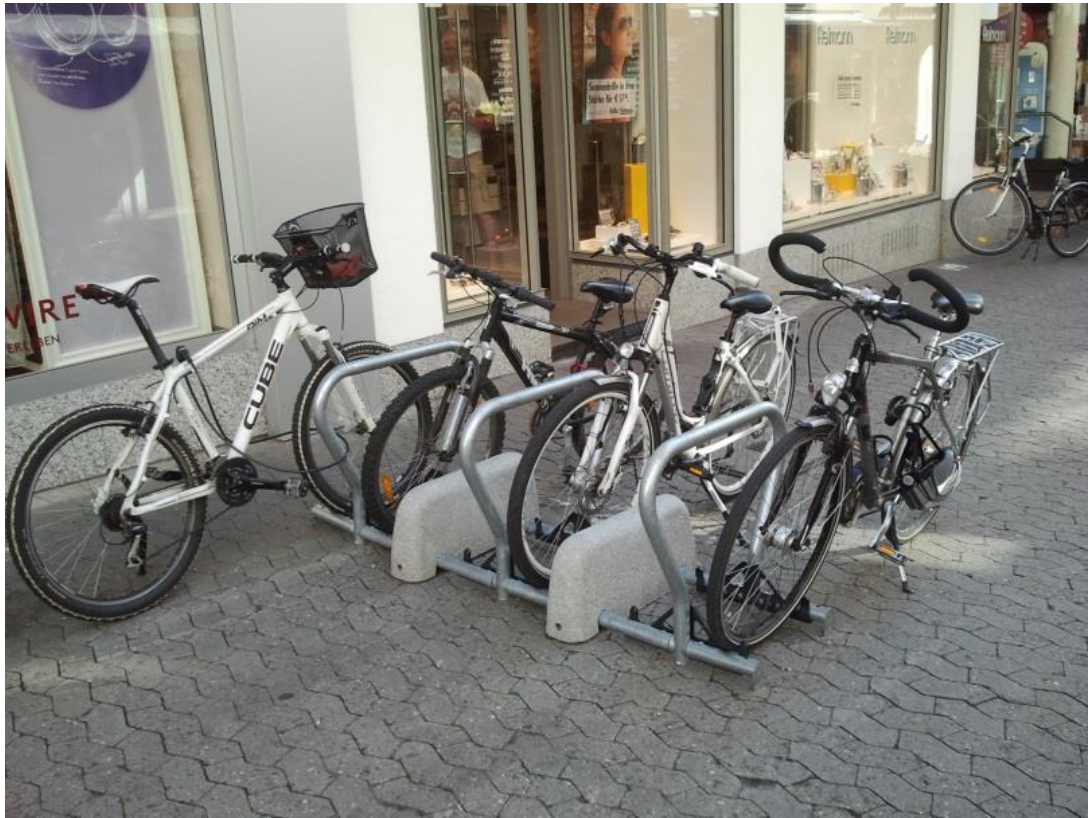
Abbildung 3: Mobile Radabstellanlagen, welche die Mindestanforderung an Standsicherheit und Diebstahlschutz erfüllen [Foto: R+T]
